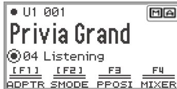
[M] ....S'allume lors de la connexion à un appareil compatible avec la norme MIDI Bluetooth Low Energy.
